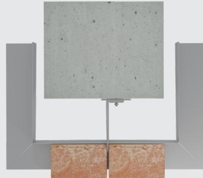
**PFC 62/1 EINZELMODUL AUFHÄNGERKONSOL - VORGEFERTIGTER BETONMODUL MIT VERTIKALE RIEMCHEN**
