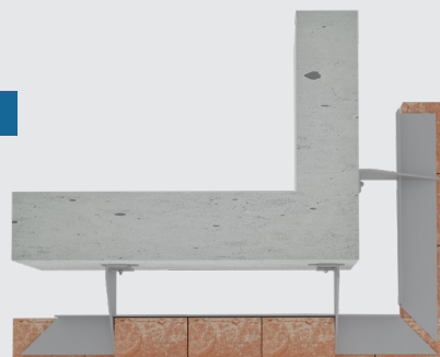
PFC 67/2-J45 KÉTMODULOS FERDESARKOS TÁMPROFIL KONZOL - SAROK KIALAKÍTÁS ZÁRT FUGÁVAL
