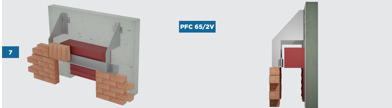
PFC 65/2V KÉTMODULOS TÁMPROFIL KONZOL LEFÜGGESZTÉSSEL REDŐNYTOK ELÉ - LÁTHATÓ KIVITELBEN
