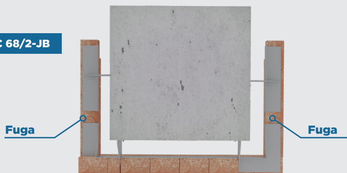
PFC 68/2-JB JOBBOS-BALOS KÉT SAROKLAPOS KONZOL PILLÉR KÖRÜLI SAROK KIALAKÍTÁS NYITOTT
