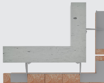
PFC 68/2J JOBBOS KÉTMODULOS SAROKLAPOS PROFILKONZOL - SAROK KIALAKÍTÁS NYITOTT FUGÁVAL
