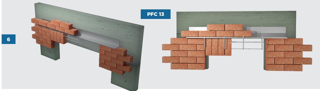
PFC 65/2V KÉTMODULOS TÁMPROFIL KONZOL LEFÜGGESZTÉSSEL REDŐNYTOK ELÉ - LÁTHATÓ KIVITELBEN
