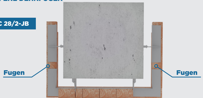
PFC 28/2-JB ZWEI MODULE TRAG-PROFILKONSOL MIT RECHTE- LINKESEITE ECKEPLATTEN -ECKE WANDECKE AUSGESTALTUNG MIT ZWEISEITIGE OFFENE DEHNFUGEN
