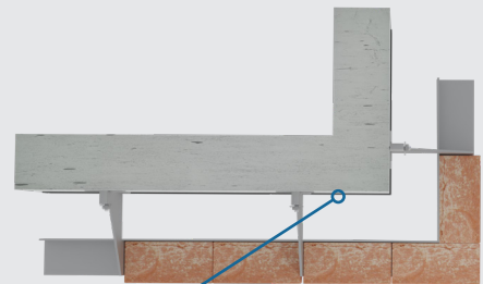
PFC 28/2V/J ZWEI MODULE TRAGKONSOL MIT RECHTZEITIGE ECKEPLATTE - MIT AUFHÄNGE GESCHLOSSENE ECKE
