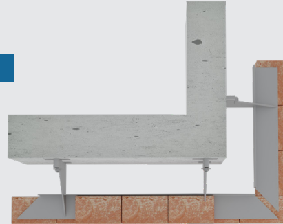
PFC 27/2-J45 ZWEI MODULE SCHRÄGECKE TRAG-PROFILKONSOL - WANDECKE AUSGESTALTUNG MIT GESCHLOSSENE FUGE
