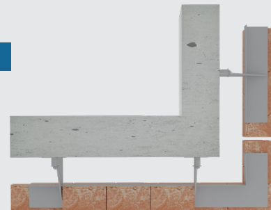
PFC 28/2J ZWEI MODULE TRAG-PROFILKONSOL MIT RECHTSEITIGE ECKEPLATTE - WANDECKE AUSGESTALTUNG MIT OFFENE DEHNFUGE
