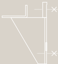
2F - obere Tragkonsole mit zwei Dübeln
