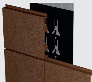
8. Max. 5 mm vékony lap rögzítése ragasztással
